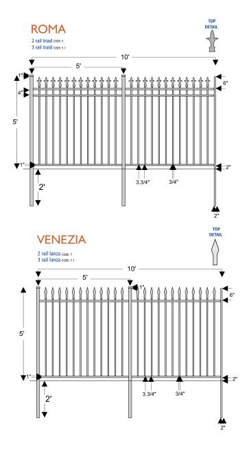
MECHANICAL FENCE MODEL FENCE - FRONT VIEW
